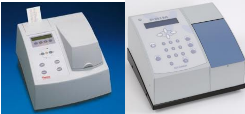
Σχήμα 9.8: Φασματοφωτόμετρα ορατού φωτός (απλής δέσμης) που χρησιμοποιούνται στις εργαστηριακές ασκήσεις.
