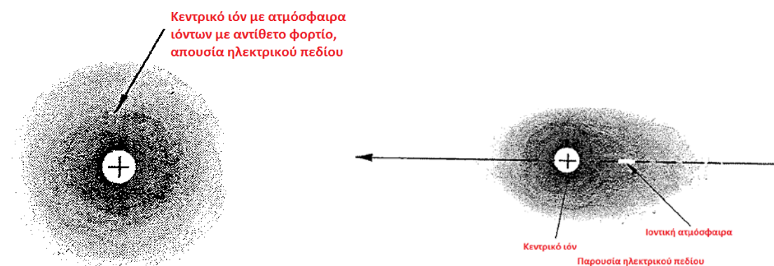
Σχήμα 6.18: Φαινόμενο ασυμμετρίαςσε ηλεκτρολυτικό διάλυμα.
